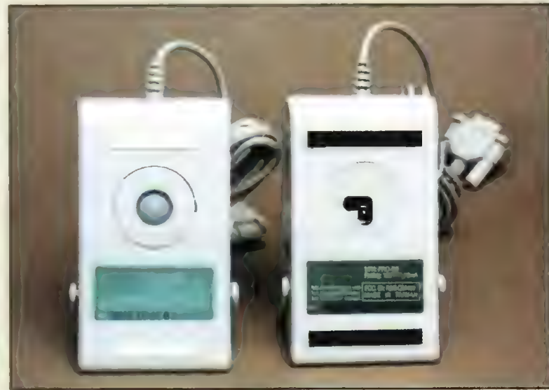
6. W myszy optomechanicznej ruchy ręki przenoszone są za pomocą kulki (po lewej). Mysza optyczna nie ma elementów mechanicznych.
